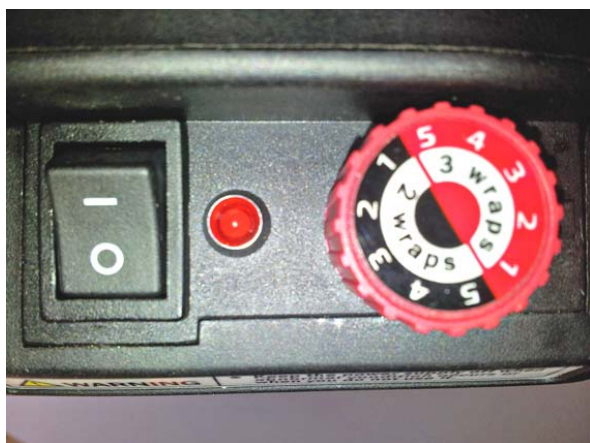
Рис.: 1. Ручка установки крутящего момента
