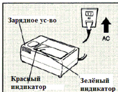
Рис.: 1. Зарядное устройство 2. Красный индикатор заряда 3. Зелёный индикатор режима ожидания 4. Сеть переменного напряжения
